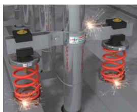
스프링 하부 용접
