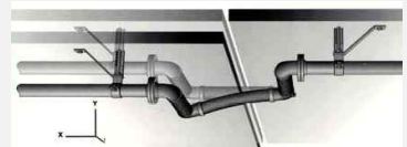
-수직변위 발생 시 제어모습-
